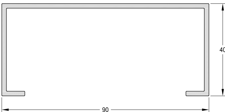
1090114 - Canal Liso 90 x 40 mm. Peso: 0,98 Kg/m. Largo Std.: 6.030 mm.
